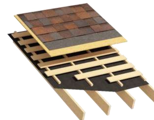
Кровельная панель без утепления с подготовкой под мягкую кровлю
