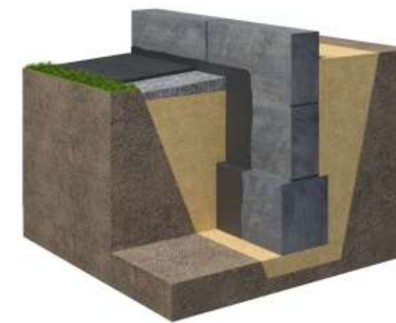
Ленточный фундамент из блоков ФБС
