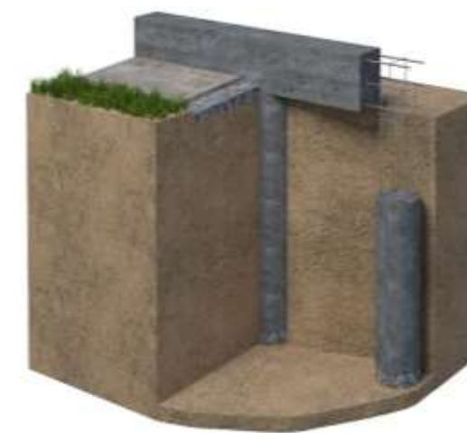
Фундамент из буронабивных свай
