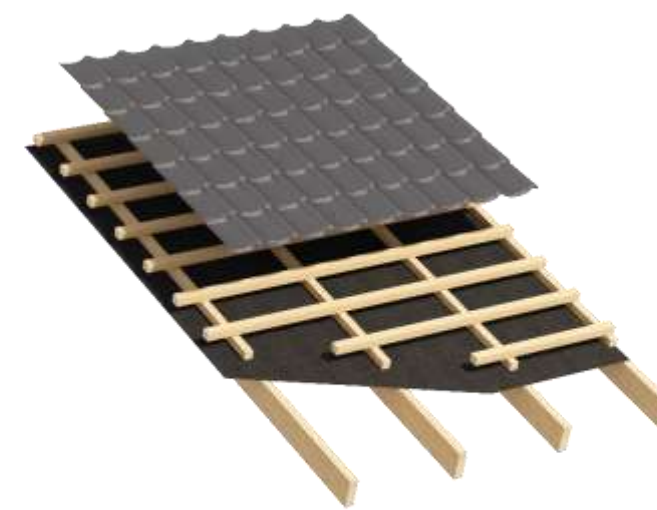
Кровельная панель без утепления с подготовкой под металлочерепицу
