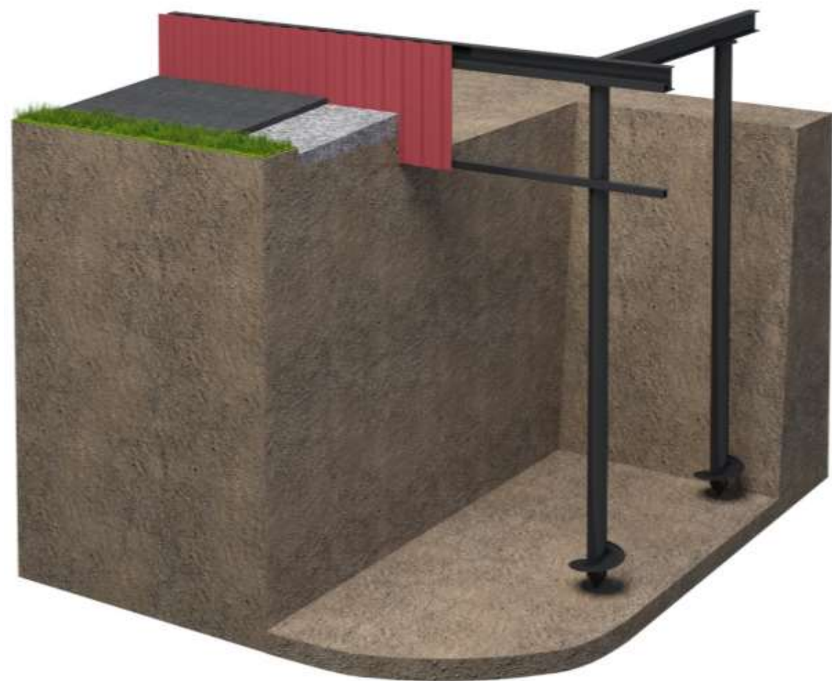
Фундамент на винтовых сваях
