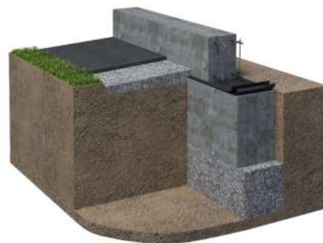
Ленточный монолитный фундамент
