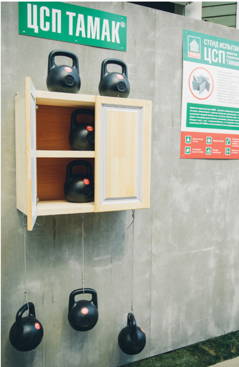
Испытание ЦСП ТАМАК 12 мм на нагрузки весовых конструкций, весовая нагрузка 7 гирь по 32 кг – 224 кг
