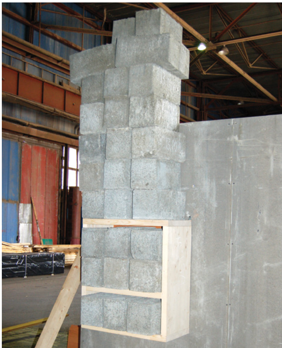
Испытание ЦСП ТАМАК 12 мм на предельные нагрузки навесных конструкций. Общий вес 406,5 кг, две точки подвеса
