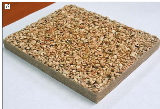
Рис. 1. Цементно-стружечная плита: а – без отделки; б – с отделкой крупной крошкой марки Kotak Plat
