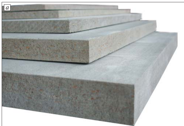
Рис. 1. Цементно-стружечная плита: а – без отделки; б – с отделкой крупной крошкой марки Kotak Plat
